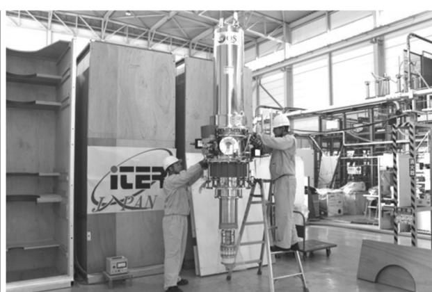
図2 世界で初めて完成したITER用ジャイロトロン。
