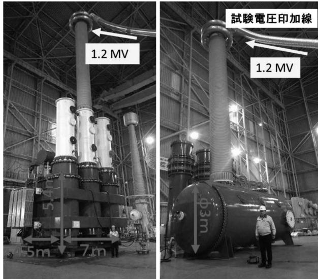
図2 直流1MV超高電圧発生器：昇圧変圧器（左），
