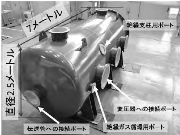
図3 20万ボルト整流器用圧力容器の完成。
