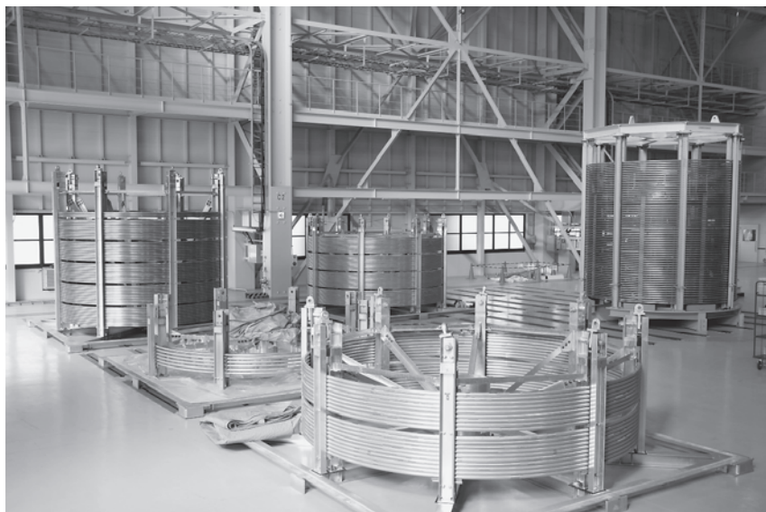
図2 直径4 mに巻き取られた導体(左奥: 中国製ダミー導体, 右奥実機TFコイル用の韓国製TF導体, 他: 日本製TF導体)。
