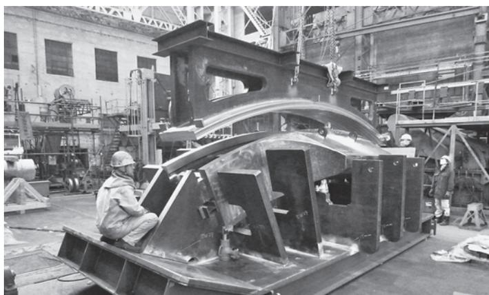
図 3 コイル構造物の実規模試作。
