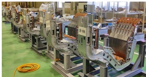
図 4 JT-60SA 用ダイバータモジュール.
