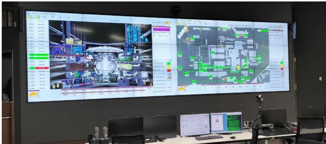
図2 遠隔実験室大画面にライブ表示されたITER主制御室のオペレータインタフェース。
