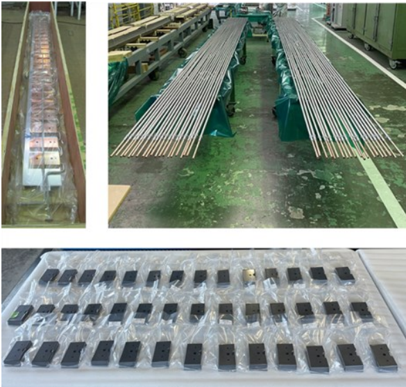
図2 製作が完了したヒートシンク（左上），抵抗性壁モード制御コイル用フィーダー（右上），ダイバータ用炭素タイル（下）。
