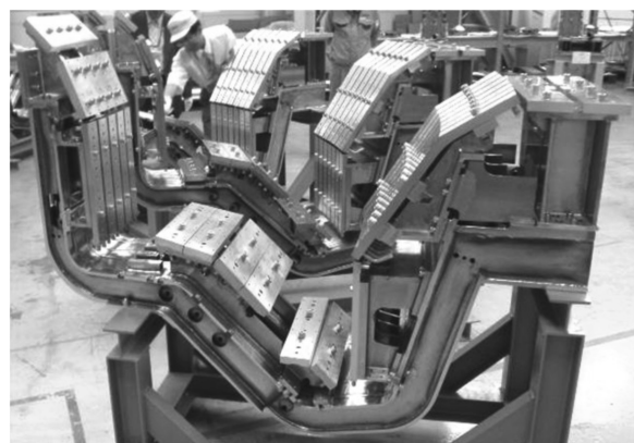
図5 JT-60SAのダイバータカセットのフレーム。アーマータイルは未装着の状態。
