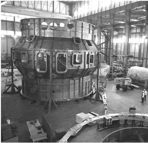
図3 仮組みされたクライオスタット胴部の全容.
