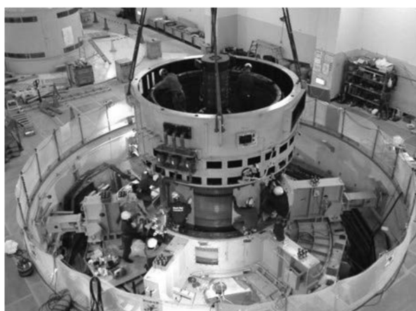
図5 フライホイール付き電動発電機（H-MG）のオーバーホール（固定子の引き抜き作業）。
