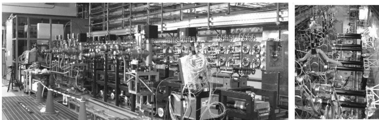
図2 据付が進行中のRFQ本体（左）と高周波伝送系（右）。
