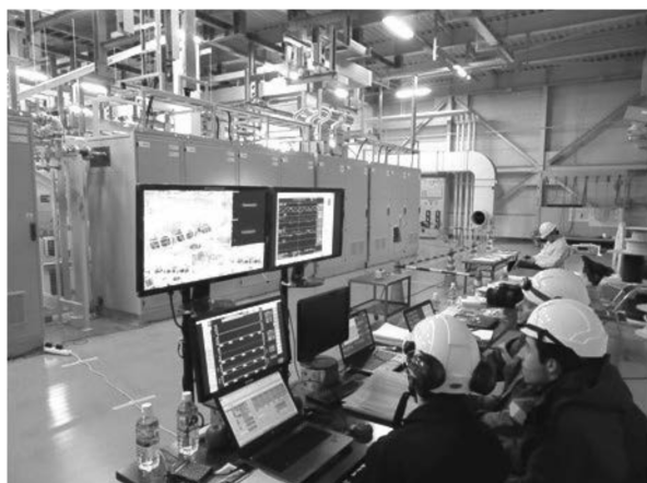
図4 平衡磁場コイル用直流電源の通電試験に向けた準備。
