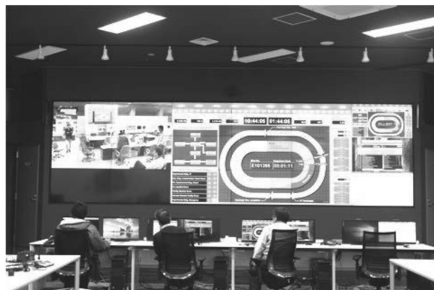
図 3 遠隔実験室（青森県六ヶ所村）から JT-60SA（茨城県那珂市）への遠隔実験を実施している様子。那珂核融合研究所との TV 会議（左）、制御シーケンス及び施設のモニター（中央）、放電スケジュール等の表示（右）。
