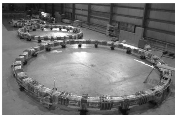
図5 製作が完了し組立を待つ上側EFコイル3機.
