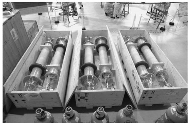
図5 TFC用高温超伝導電流・リードが完納。
