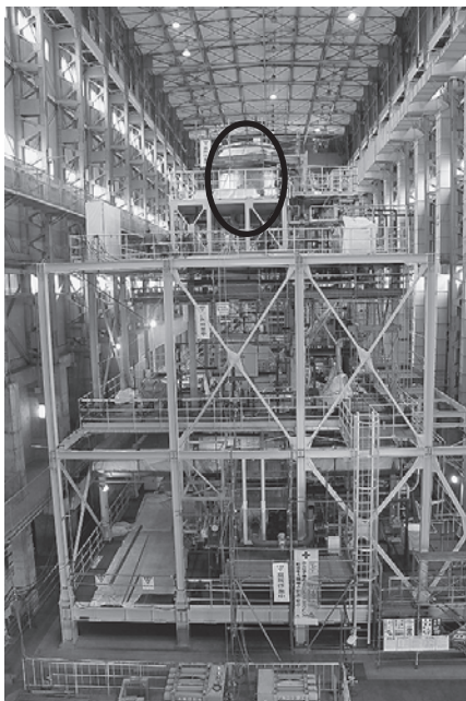
図1 6月末時点におけるリチウム試験ループの全体写真。赤丸で囲まれた部分は、ターゲットアセンブリーと呼ばれる液体リチウムが高速（15～20 m/s）で流れる最重要機器が格納されている容器。
