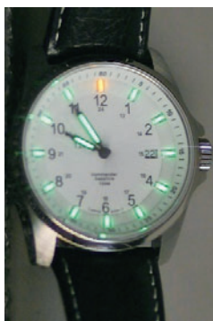
図1 トリチウムによる放射線ルミネッセンスを利用した腕時計 (I, Autopilot, Swiss Military Watch Commander model with tritium-illuminated face, https://en.wikipedia.org/wiki/Radioluminescence#/media/File:Tritium-watch.jpg ).
