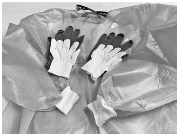
図5 個人防護装備(PPE)の一例、ゴーグル、ポリエチレン製手袋、ゴム手袋、綿インナー手袋および防水加工エプロン。
