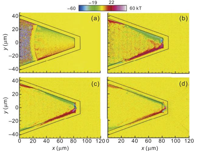
図4 各時間における  $B_z$  磁場分布(a)0.5 ps, (b)1.5 ps, (c)2.5 ps, (d)3.5 ps. 文献[8]より抜粋.
