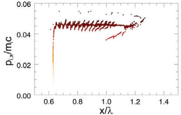
図8 円偏光レーザーを使ったPICシミュレーションにより得られた  $t = 30 T_0$  における加速イオンの位相空間分布。レーザーおよびターゲットパラメータは図6に同じ。
