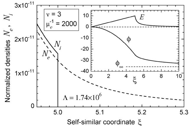
図2 イオンフロント周辺( $\xi = \xi_f = 5$ )の規格化されたイオン密度 $N_i$ 、電子密度 $N_e$ 、電界ポテンシャル $\Phi$ 、電場 $E = -d\Phi/d\xi$ (文献[11]より抜粋)。ただし球幾何( $\nu=3$ )およびプロトン( $\mu_e^{-1}=2000$ )を仮定。
