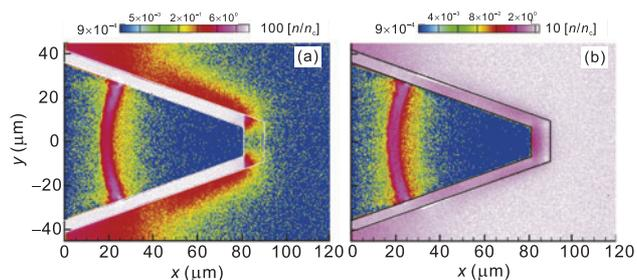
図 2  $t = 0.8\ \text{ps}$  におけるコーン壁周辺の密度分布。最大密度が (a)  $100n_c$  及び (b)  $10n_c$  の場合 ( $n_c$  は遮断密度  $\approx 10 \times 10^{21}\ \text{cm}^{-3}$ )。文献[8]より抜粋。
