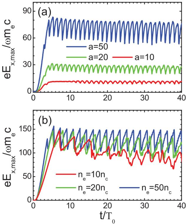
図9 電界ピーク値  $E_{x,max}$  の時間発展 (a) 電子密度が  $n_e = 100$  であるプラズマと異なるレーザー強度 ( $a = 10, 20, 50$ ) の円偏光が相互作用した場合 (b) 強度 ( $a = 100$ ) のレーザーと異なる密度 ( $n_e = 10, 20, 50$ ) のプラズマが相互作用した場合. そのほかのパラメータは図6に同じ.
