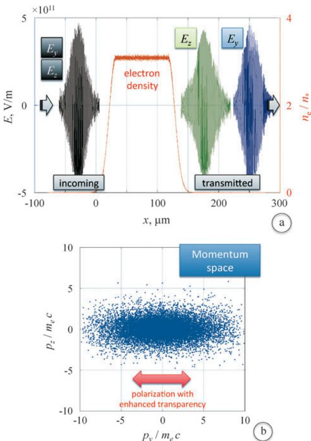
図3 (a)非等方プラズマ中の複屈折効果によるレーザーパルスの分裂 (b)レーザー伝搬方向に垂直な  $yz$  平面における電子の運動量分布。
