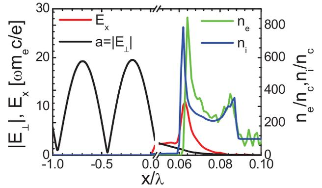
図6 円偏光レーザーパルスを使ったPICシミュレーションから得られた  $t=5 T_0$  ( $T_0$ はレーザー周期)における電子(緑)・イオン(青)の密度分布と電界強度分布.
