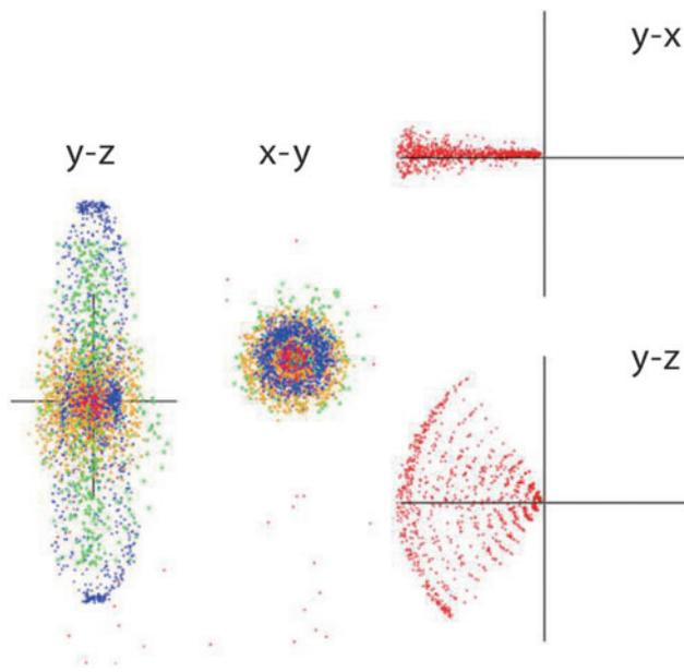
図5 レーザー強度  $5 \times 10^{17} \text{ W/cm}^2$  (S1ラン)における yz, xy プロット。(赤:電子, 青:プロトン, 緑:炭素, 黄:金)および電子 yx, yz プロット。時間は 30 fs, 縮尺は  $8.8 \times 10^{-6} \text{ cm}$  (左, 中), および  $7.5 \times 10^{-4} \text{ cm}$  (右)。
