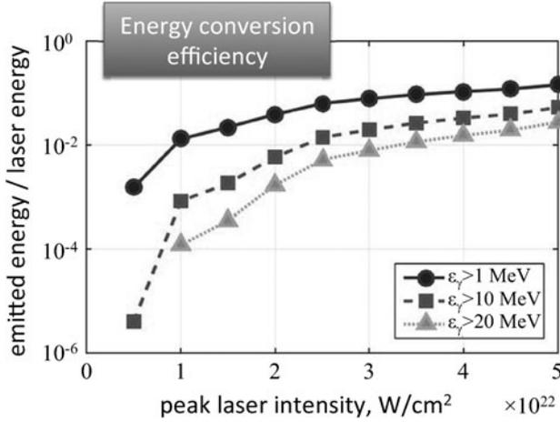
図6 異なる3つの場のエネルギー(1, 10, 20 MeV)下限を媒介変数とした場合の、レーザーエネルギーから場のエネルギーへの変換効率。
