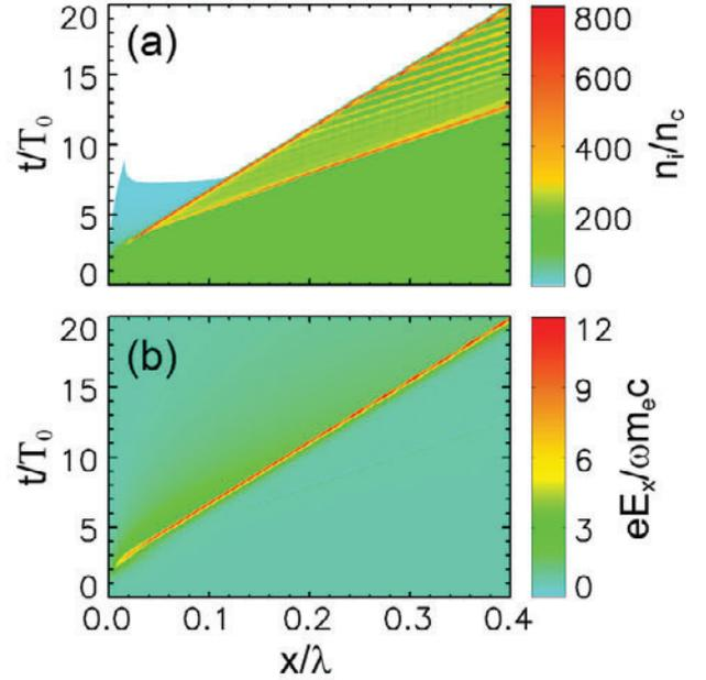
図7 (a)円偏光が厚目のターゲットに適用された場合のイオン密度  $n_i$  の時間発展。(b)  $x$  軸方向の電場の時間発展。レーザーおよびターゲットパラメータは図6に同じ。
