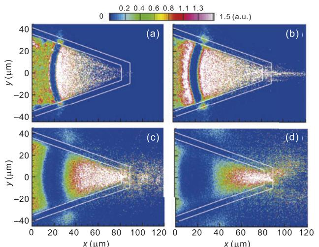
図5 各時間におけるプロトンのエネルギー密度分布(a)1.0 ps, (b)1.5 ps, (c)2.5 ps, (d)3.5 ps. 先端部における磁場密度の上昇とともにプロトンビームの発散が増幅され、結果としてコーン外部領域においてビームの空洞化が見られる。文献[8]より抜粋.
