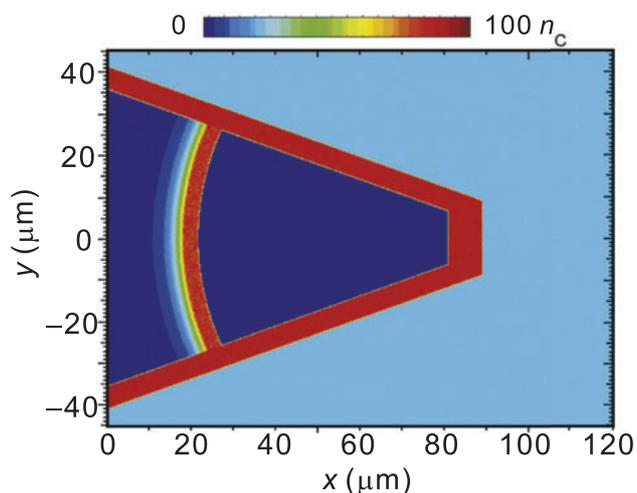
図 1 粒子シミュレーションで設定したターゲット初期配位断面図 (密度分布)。レーザー光は左方より入射し、円錐 (コーン) 中央に置かれた湾曲薄膜コンバータで吸収・反射される。吸収されたレーザーエネルギーは、まず高速電子に変換され、その大部分は右側の円錐頭頂方向に飛散する。結果としてコンバータ薄膜裏面に強力な静電場が誘起され、この静電場によって薄膜内のプロトンが加速されビームとなって円錐頭頂部より右方に射出される。文献[8]より抜粋。
