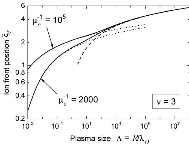
図1 球幾何( $\nu=3$ )の場合の規格化された膨張イオンフロントの座標 $\xi_f$ をプラズマの厚み $\Lambda$ の関数として表したものの(文献[11]より抜粋)。荷電分離の効果を正確に取り入れるためには電子とイオンの間の荷電質量比 $\mu_e^{-1} = m_i/Zm_e$ が重要な役割を演じる。図中、実線は数値計算結果、点線及び鎖線は解析解(21), (23)を表す。
