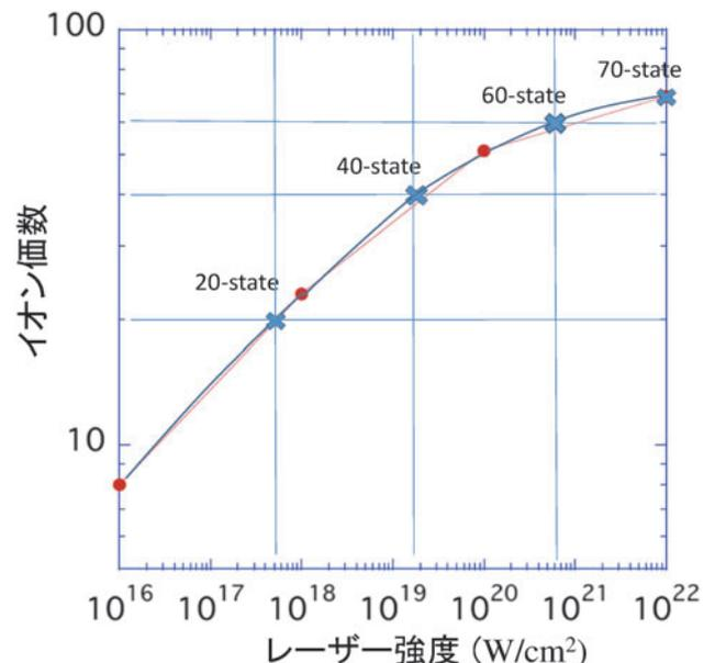
図4 レーザー強度と金のイオン価数.
