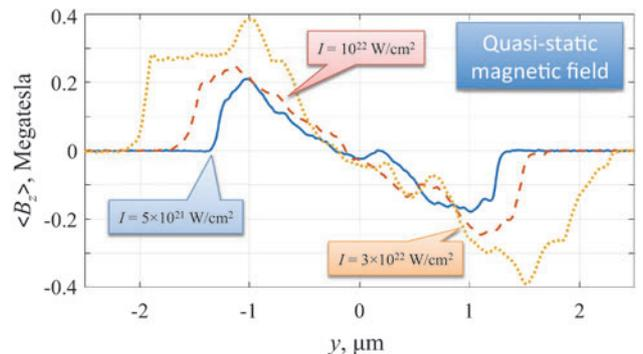
図5 各レーザー照射強度の下でのプラズマフィラメント内部の準静磁場の空間プロファイル. 図4の白点線の場所に対応.
