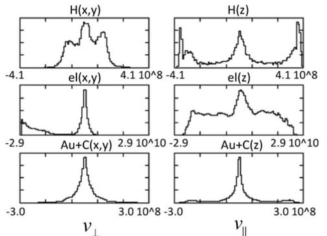
図6 レーザー強度  $5 \times 10^{17} \text{ W/cm}^2$  (S1ラン)における、(上から順に)プロトン, 電子, 炭素+金の速度分布関数。時刻は 30 fs. 左側は垂直方向 ( $V_x, V_y$ ), 右側は縦方向  $V_{||}$ , 横軸は速度 (cm/s)。
