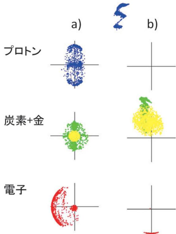
図9 (上から順に) プロトン, 炭素+金, 電子の速度分布。レーザー強度と時刻は, a)  $5 \times 10^{17} \text{ W/cm}^2, 30 \text{ fs}$  (S1 ラン), および b)  $1 \times 10^{22} \text{ W/cm}^2, 23 \text{ fs}$  (S4 ラン)。縮尺スケールは, 正イオンは a) 100倍, b) 50倍, および電子は全て 1.5倍。
