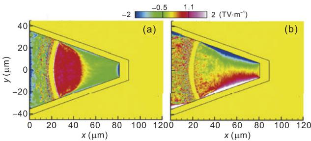
図3  $t = 0.5 \text{ ps}$  においてレーザー周期で平均された(a)縦電場  $E_x$  と(b)横電場  $E_y$  の空間配位. 文献[8]より抜粋.
