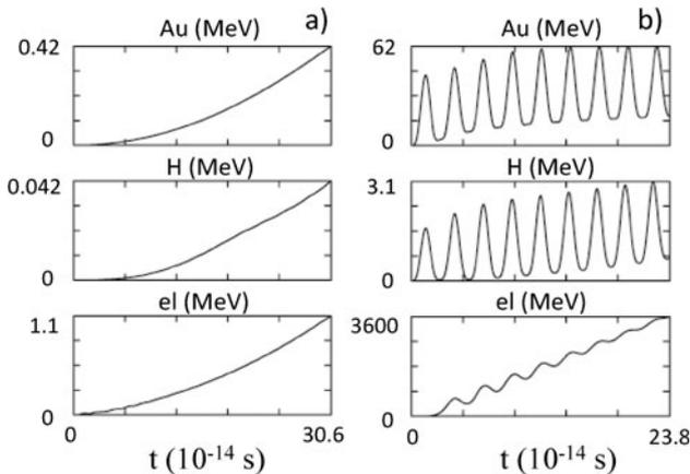
図7 レーザー強度 a)  $5 \times 10^{17} \text{ W/cm}^2$  (S1 ラン), および b)  $1 \times 10^{22} \text{ W/cm}^2$  (S4 ラン) における運動エネルギーの比較。上から順に金, プロトン, 電子。
