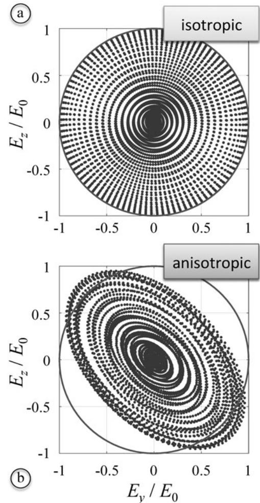
図2 初期ピーク電界振幅 $E_0$ を持つレーザーパルスの偏光分布。電子運動量分布が(a)等方(b)非等方の場合。実線は入射レーザーのピーク振幅を表す。
