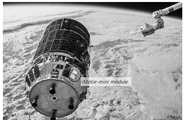
図1 軌道上で撮影された ATOTIE-mini モジュール。モジュールは宇宙空間に直接曝されている。
