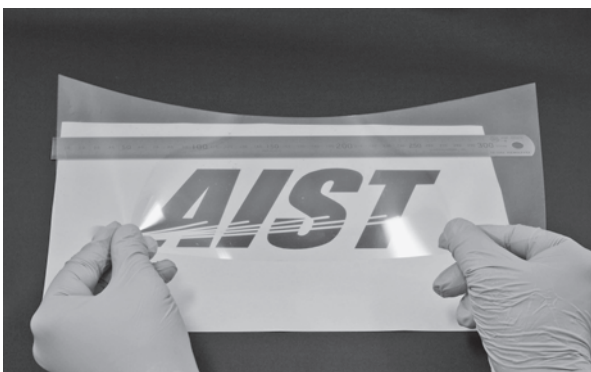
図13 ロール・ツー・ロール方式のマイクロ波プラズマCVDで合成したグラフェンによる透明導電フィルム。
