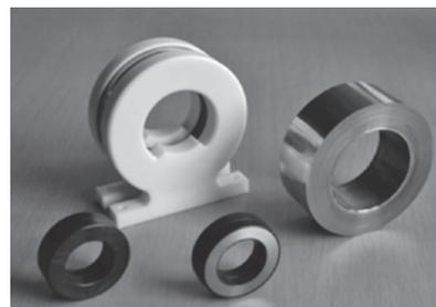
図19 トロイダル磁心材。
