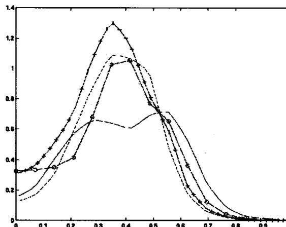
Fig. 3b CIEL2: LHCD current profile (a.u.) vs  $r/a$ . (—) first iteration, (---) 2<sup>nd</sup> iteration, (-x-) 3<sup>rd</sup> iteration, (-o-) 4<sup>th</sup> iteration.
