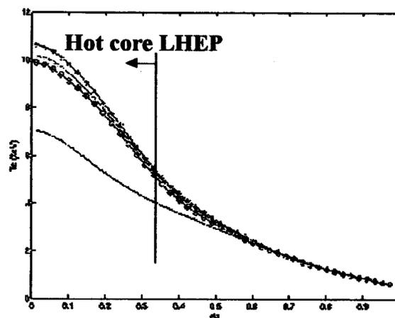
Fig. 3a CIEL2: Electron temperature profile (keV) versus  $r/a$ . (—) first guess, (---) 2<sup>nd</sup> iteration, (-x-) 3<sup>rd</sup> iteration, (-o-) 4<sup>th</sup> iteration.
