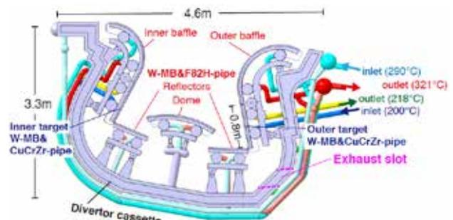
図3 ダイバータ・カセット構造
