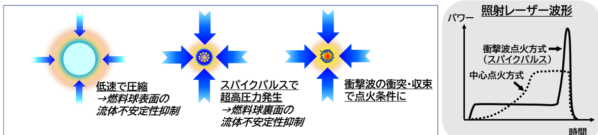
図1 (左)衝撃波点火核融合の概念(右)適用するレーザーのパルス波形
