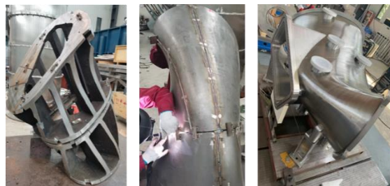
図2 組み立て用の型 (左)、薄板の溶接 (中)、分割フランジ・ポートを取り付けた状態 (右)
