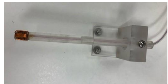
Fig 1:エッジ部での磁場測定用の磁気プローブの写真
