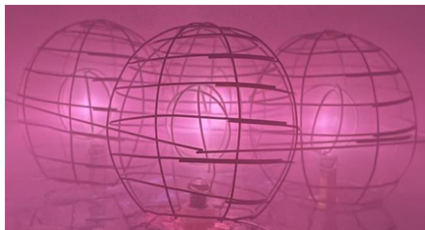
図1. 8cm球形電極を2×2個配置した放電写真 (4つめの電極は奥に配置されている)
