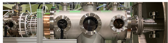
図 2: Pilot 装置に設置した直流アークプラズマ源 (左端) 中央: 差動排気チャンパー、右端: 超伝導コイル。
