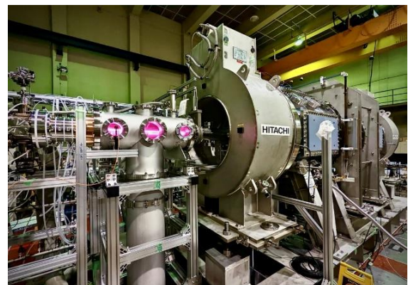
図2 ファーストプラズマ生成実験時の装置写真。エンド領域に熱陰極直流アークプラズマ源と差動排気系が設置されている。差動排気チャンバー内を通過する水素プラズマが見えている。
