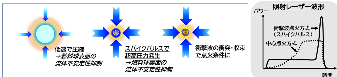
図1 (左)衝撃波点火核融合の概念(右)適用するレーザーのパルス波形
