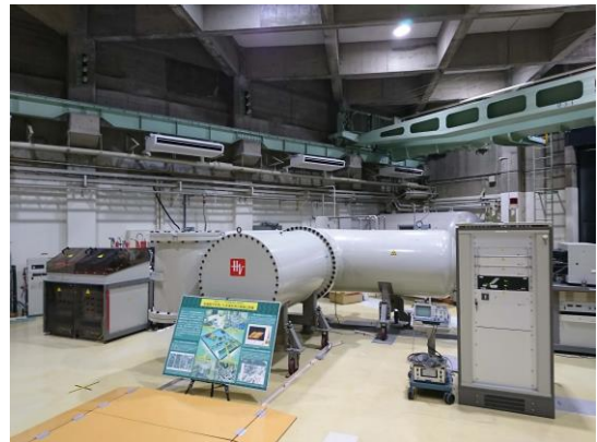
図1 DuETのHVEE社製のタンデム型加速器（写真中央）とスパッタ型およびデュオプラズマ型のイオン源（写真左）。
