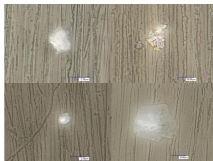
図-2 : プラズマ蒸着された粒子の光学顕微鏡写真。
