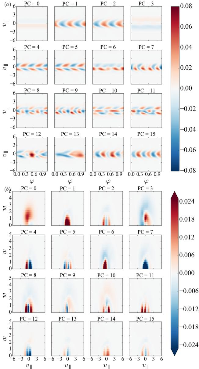
Fig. 1: 第 16 主成分までの位相空間基底の断面図。(a)  $w = 0.12$  における  $(\varphi, v_\parallel)$  断面図と (b)  $\varphi = 0$  における  $(v_\parallel, w)$  断面図。
