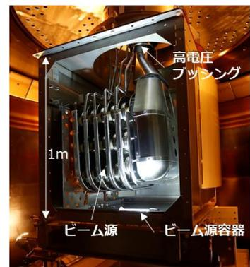
図 2. ITER 加速器耐電圧試験体
