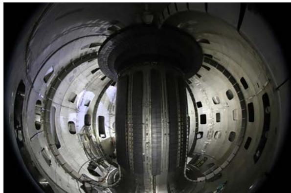
図2 第一壁や計測機器が設置された真空容器内
