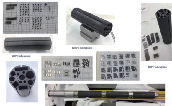
図1 日米科学技術協力事業PHENIX計画のもと米国研究炉HFIRで照射された試料と黒鉛試料ホルダー [4].
