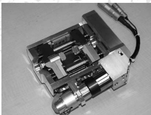
OIM 用試料引張装置(Max 1500N)
