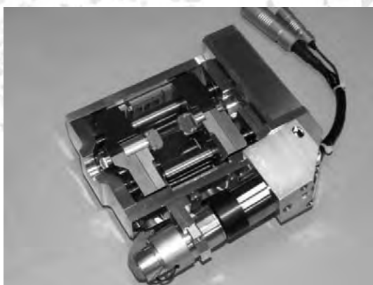
OIM 用試料引張装置(Max 1500N)
