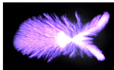
図 2 ミリ波放電に見られるフィラメント構造
