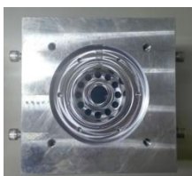
図3. 冷却水配管加工
