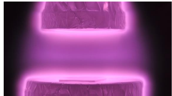
図1 準大気圧ヘリウムプラズマ生成の様子 (ガス圧力: 1.2 kPa)
