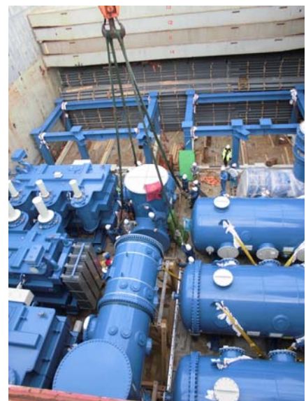
図2 伊・パドバに建設中のNBTFに向けて船積みされた 1 MV 直流高電圧電源。
