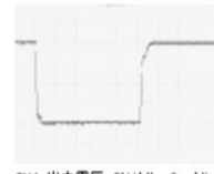
CH4: 出力電圧 5kV/div, 2us/div
