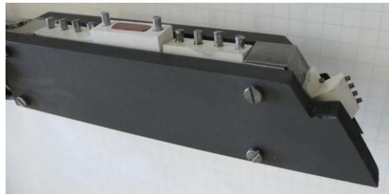
Fig. 1 Radial array probe
