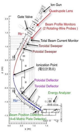
IBP システム概略図:Rb+, $V_{GUN}=14keV$ , $V_{PS}=-200V$ , $Z_i=-5cm$ (It=90kAT, $I_P=0$ , $I_V=0$ )での軌道計算例
