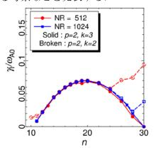
周辺局在 MHD モードの成長率を,数値積分法の次数 k を変えた HEM-GL で評価した結果.低次の場合にはメッシュ数が不十分だとスペクトル汚染が生じている.
