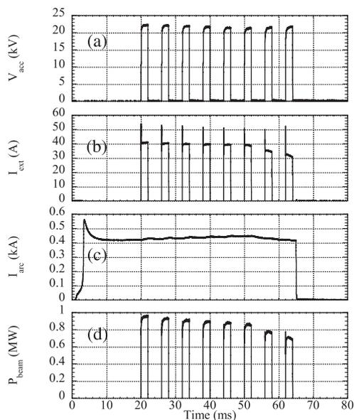
Fig. 5 Time evolutions of short-pulse helium ion beam: (a)  $V_{arc}$ , (b)  $I_{ext}$ , (c)  $I_{arc}$ , and (d)  $P_{beam}$ .
