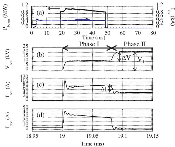
Fig. 4 Time evolutions of helium ion beams: (a)  $P_{\text{beam}}$  and  $I_{\text{arc}}$ , (b)  $V_{\text{arc}}$ , (c)  $I_{\text{arc}}$ , and (d)  $I_{\text{dec}}$ .
