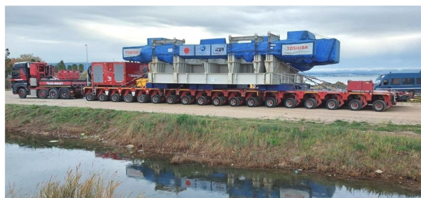
図4 東芝製初号機のマルセイユからの陸送風景。赤い車両がSPMT。
