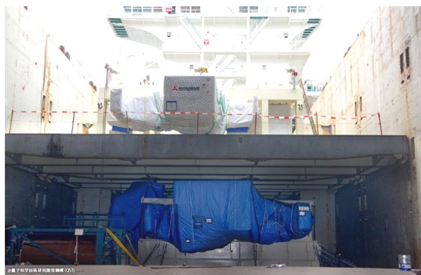
図1 在来船積み込み後のTFコイル。上段が三菱重工製、下段が東芝エネルギーシステムズ製のTFコイル。
