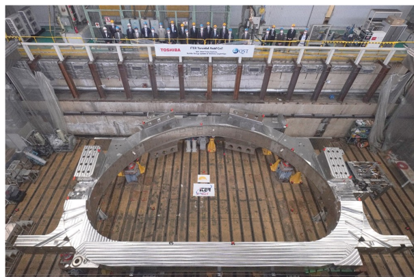
図1 東芝エネルギーシステムズ(株)が製作したTFコイル初号機 (同社提供)。
