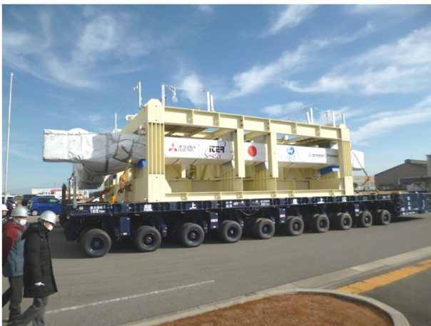
図 1 出荷時の TF コイル 4 号機。
