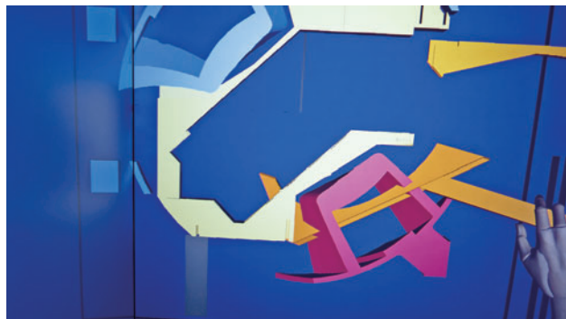
図2 ヘリカル型核融合エネルギー原型炉のVR可視化。パーツを仮想的な「手」でつかみ、つかんだパーツが別のパーツと接触したため赤く表示されている。
