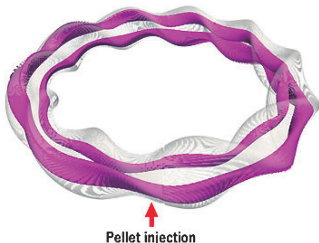
図3 水素ペレット入射の溶発により形成されたペレットクラウド。 m/n = 2/1 の構造を持ってプラズマ中に現れる。
