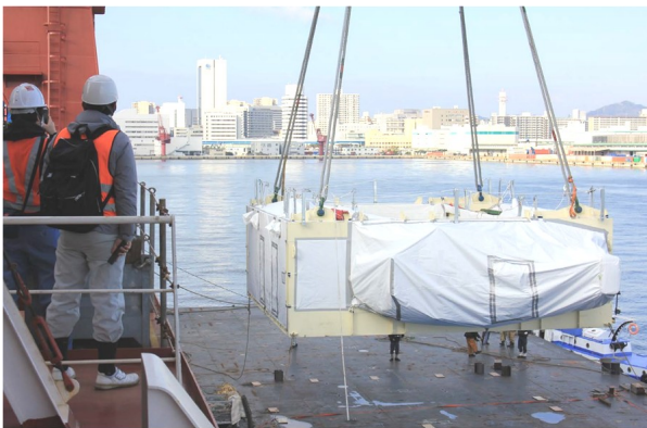
図 1 トロイダル磁場コイル初号機の本船積み込み。
