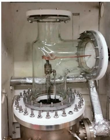
図2 改造後のH<sup>4</sup>test試験部。
